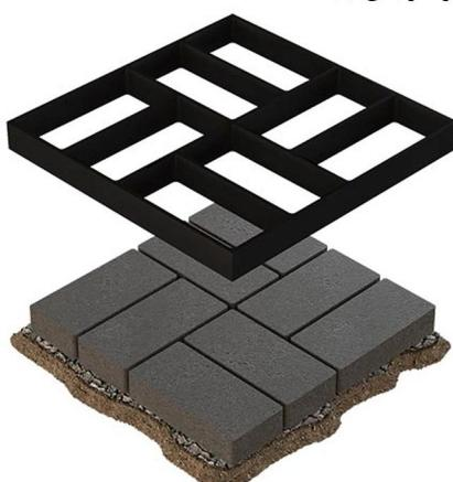
■ یکی از مهم ترین اصول برای سنگ فرش کردن محوطه با کمک قالب پلاستیکی کفپوش بتنی ، شرایط فیزیکی ویژه ملات سیمانی ، برای ریختن در قالب ها می باشد . در نظر داشته باشید که عیار ملات مصرفی برای کفسازی نباید از ۳۰۰ کمتر باشد و پیشنهاد می شود عیار نرمال ۳۵۰ برای ساخت ملات سنگفرش بتنی در نظر گرفته شود .
