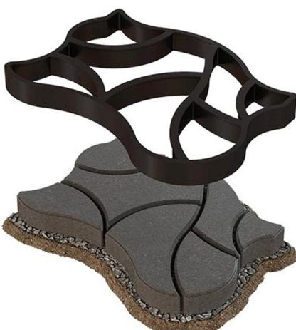
نکته مهم دیگر استفاده از ملات یا بتن با اسلامپ ۴ تا ۶ برای سنگفرش کردن محوطه به کمک قالب سنگفرش بتی می باشد . در نظر داشته باشید که در صورت استفاده از بتن با روانی زیادتر از محدوده مجاز دکر شده ، سیکل کاری و زمان قالب برداری و زمان گیرش ، افزایش خواهد یافت.
